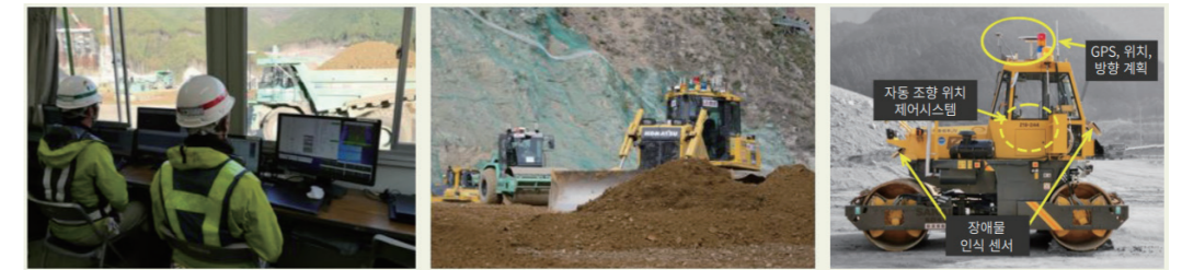
| 그림 6. 고이시하라가와댐 중장비자동화 현장 실증 |
