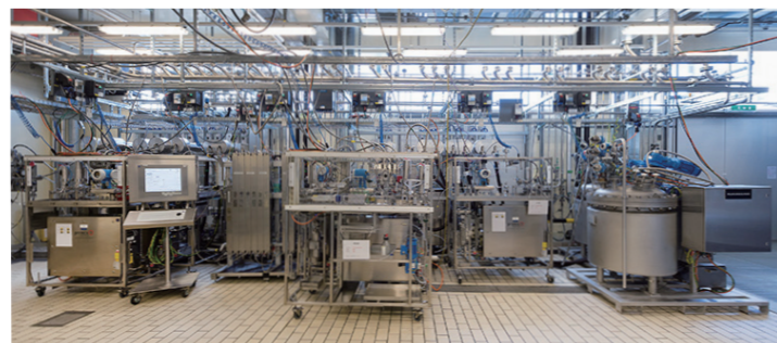
| 그림 4. Novartis 사의 정제 생산을 위한 연속 공정 설비 |
