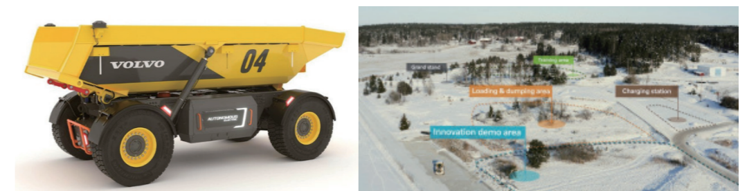
| 그림 19. 볼보건설기계 무인 트럭 파일럿 모델 및 자율주행 시험장 |
